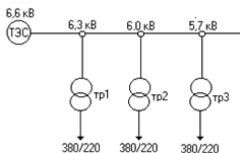
Рисунок 1.6 - Пояснение к регулированию напряжения на трансформаторе
